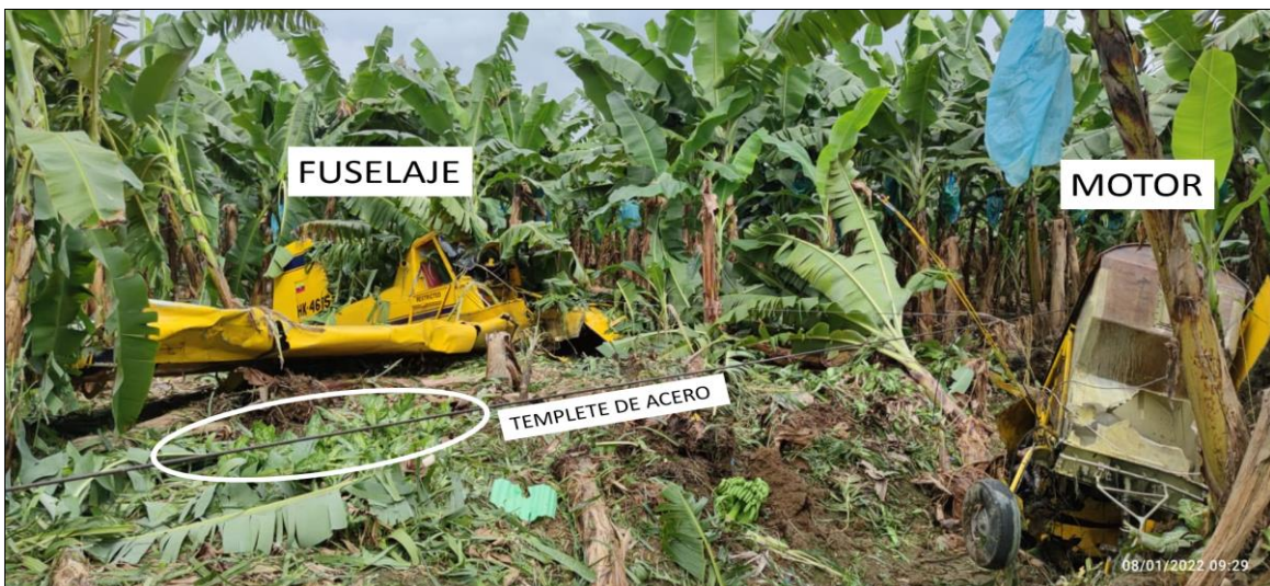
Fotografía No. 3: Disposición final de las partes de la aeronave
