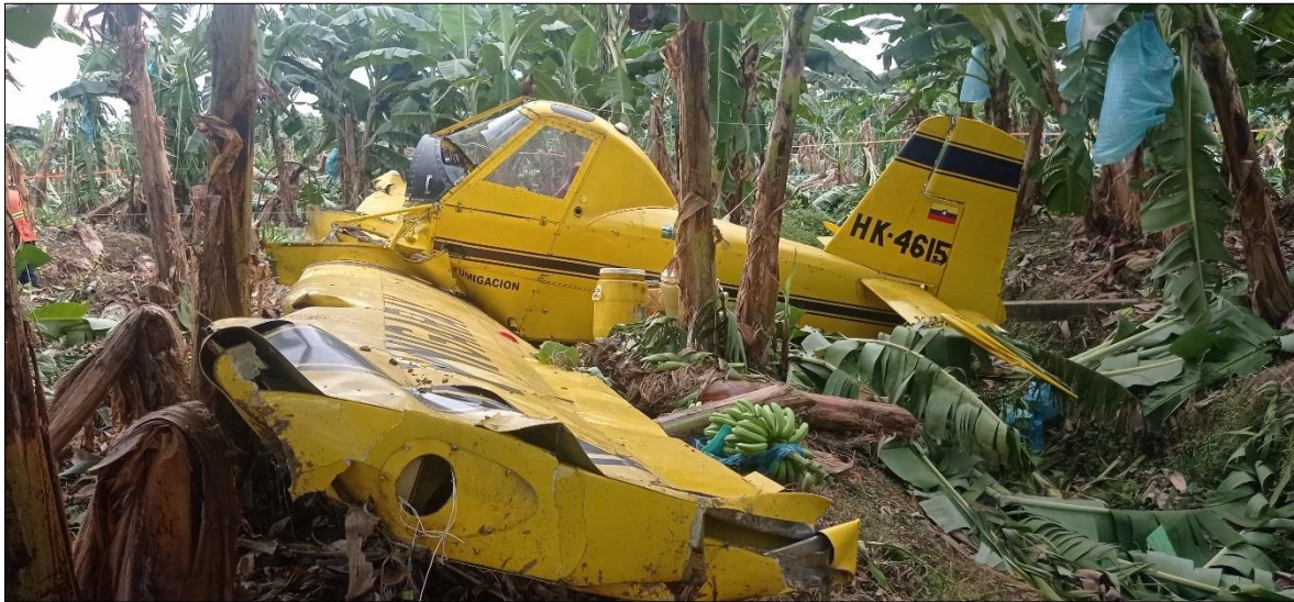
Fotografía No. 6: Daños sustanciales en el plano izquierdo.
