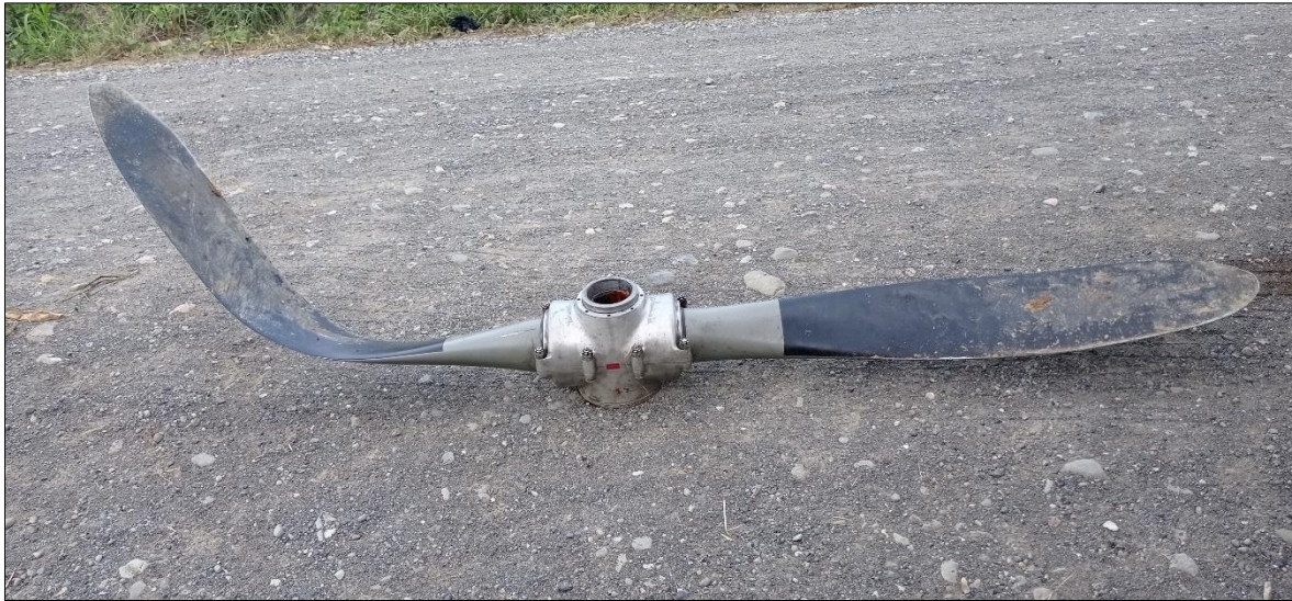
Fotografía No. 4: Estado final de la hélice.
