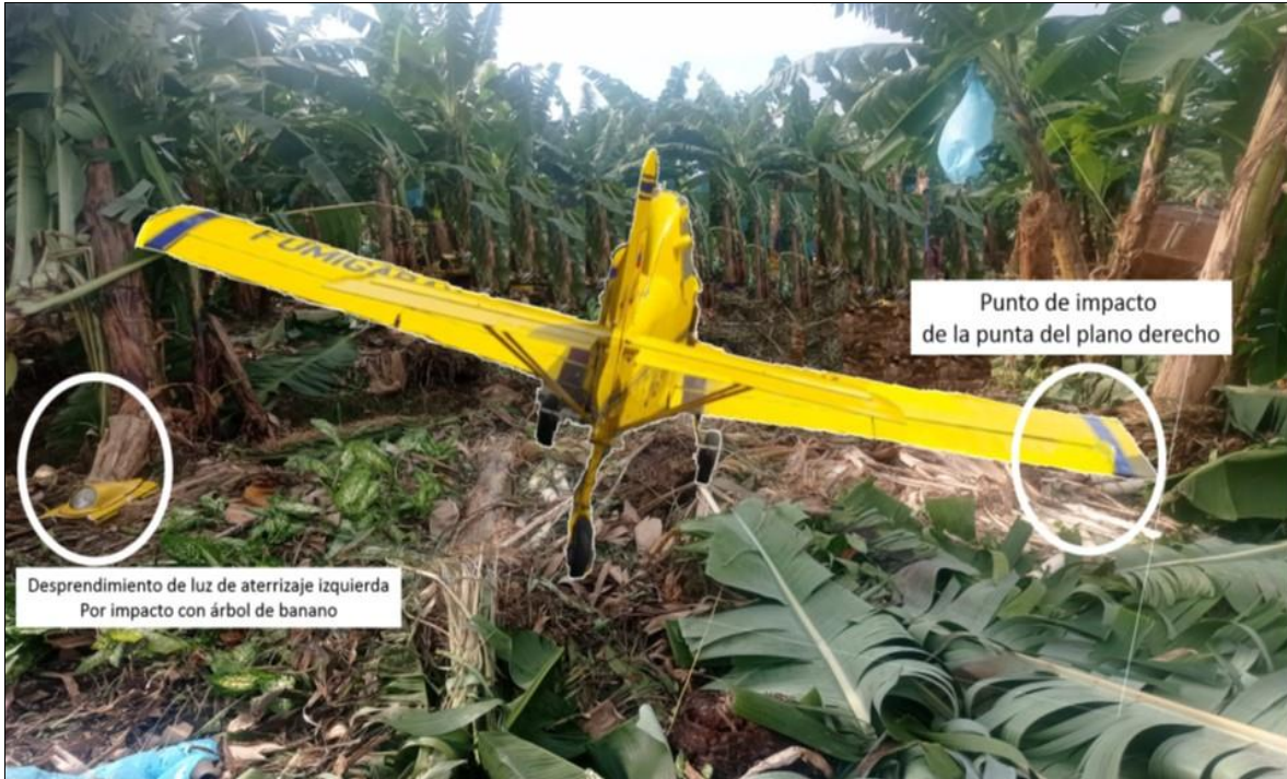
Figura No. 5: impacto de la punta del plano derecho contra el terreno.
