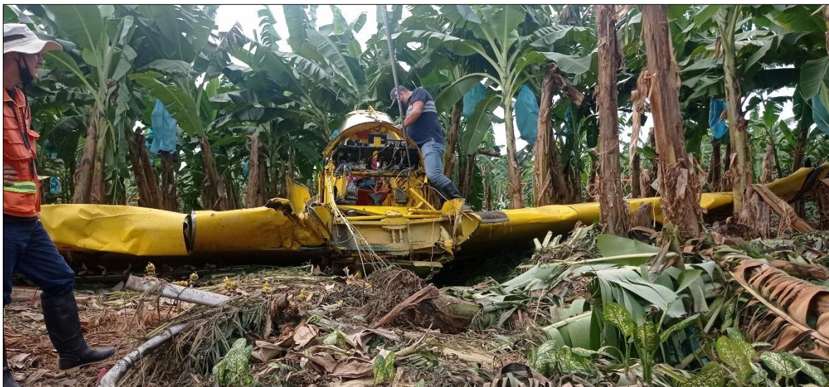
Fotografía No. 5: Daños en la parte frontal de la aeronave y en los bordes de ataque de los planos.
