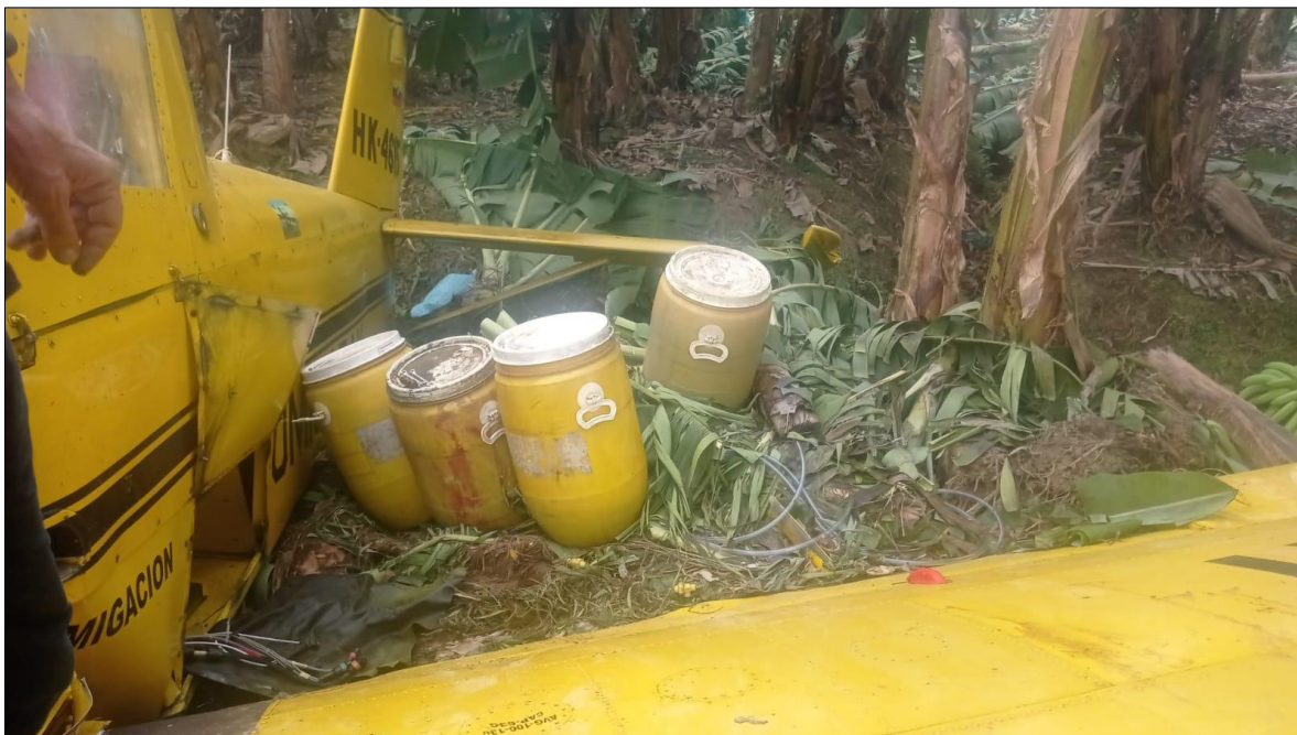
Fotografía No. 7: Combustible drenado de los planos de la aeronave.
