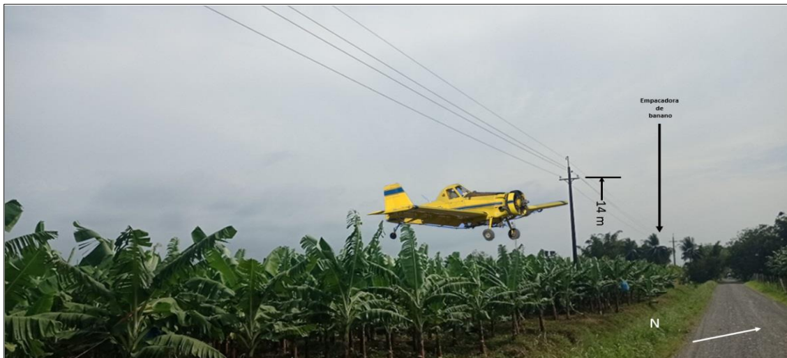
Figura No. 3: Simulación cruce de la aeronave por debajo del tendido eléctrico.
