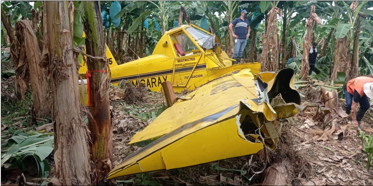
Fotografía No. 2: Daños sustanciales en el plano derecho
