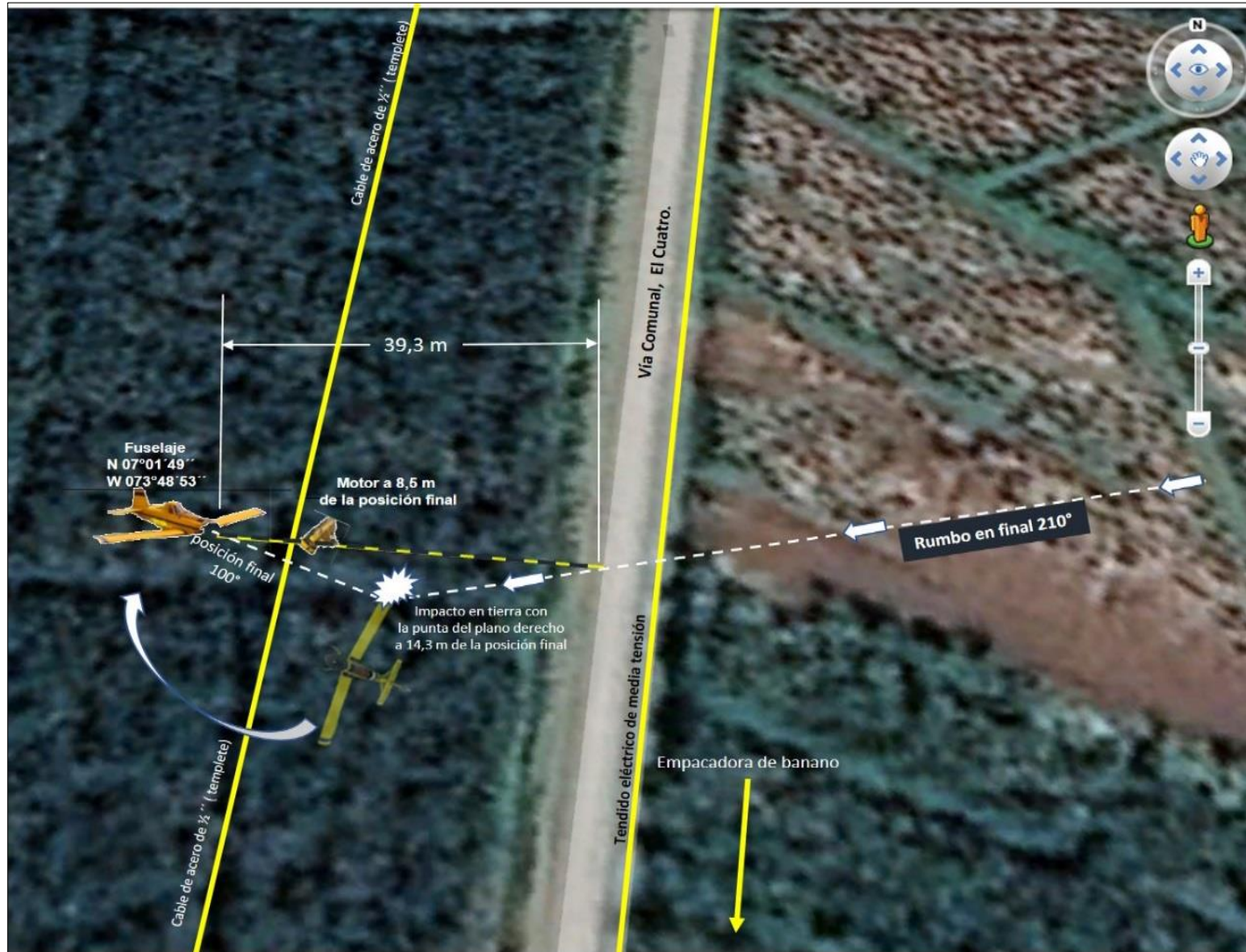
Figura No. 6: Croquis de la disposición final de los restos de la aeronave.
